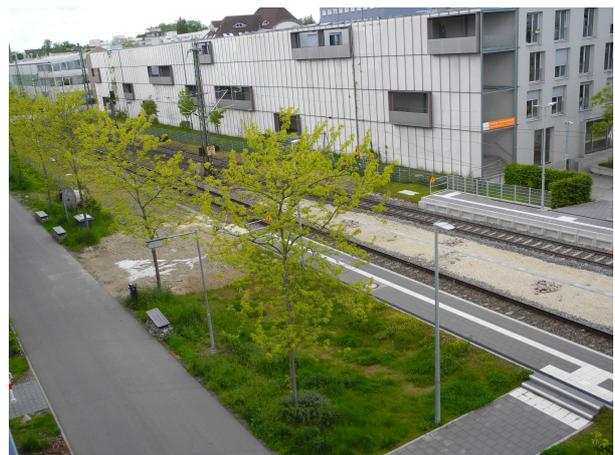
**4. b)** Durch die schweren (Raupen-) Baumaschinen wurde auf der Südseite auf der ganzen Strecke, v. a. bis zum mittleren Zugang, das Erdreich verdichtet (Im Bild: braune, vegetationslose Stellen). Die Verdichtung ist auch daran erkennbar, dass bei Regen hier das Wasser nicht versickert, sondern über mehrere Tage zusammenhängende Wasser-Flächen bildet, auf denen sich Enten ansiedeln.
